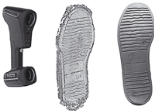
Рис. 3. Изображение 3D модели следа подошвы, полученной при помощи «SCANTECH AXE-B17» (разрешение 0,2 мм).
