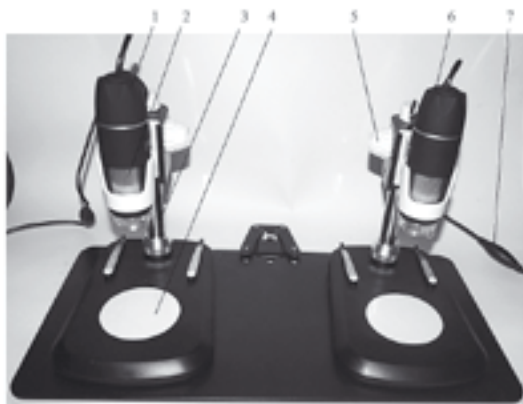
Рис. 1. Оптико-электронная установка для сравнительного исследования одновременно двух объектов: 1 – микроскоп № 1; 2 – настройка увеличения изображения; 3 – штатив; 4 – предметный столик; 5 – ручка настройка глубины резкости; 6 – микроскоп № 2; 7 – реостат яркости освещения.
