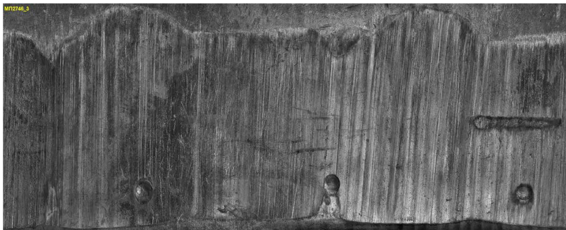
Фото 2. Следы сверловки «Ланкастер» на ведущей части выстреленной пули (охотничий карабин АК–366 Ланкастер кал. .366 ТКМ, пуля FMJ): 1 – след поля нарезки; 2 – след нарезки
