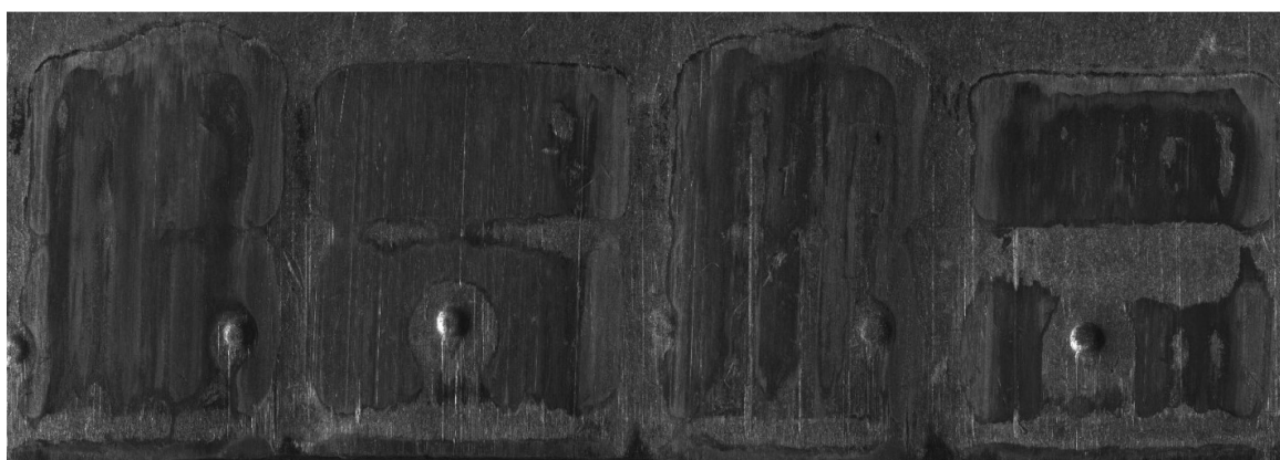
Фото 3. Следы сверловки «Ланкастер» на ведущей части выстреленной пули (охотничий карабин КО–44 Ланкастер кал. 9,6x53 Ланкастер, пуля FMJ): 1 – след поля нарезки; 2 – след нарезки
